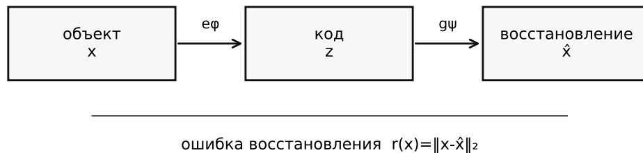
Рис. 11.1. Автоэнкодер сжимает объект в латентный код и восстанавливает его по ошибке реконструкции.
