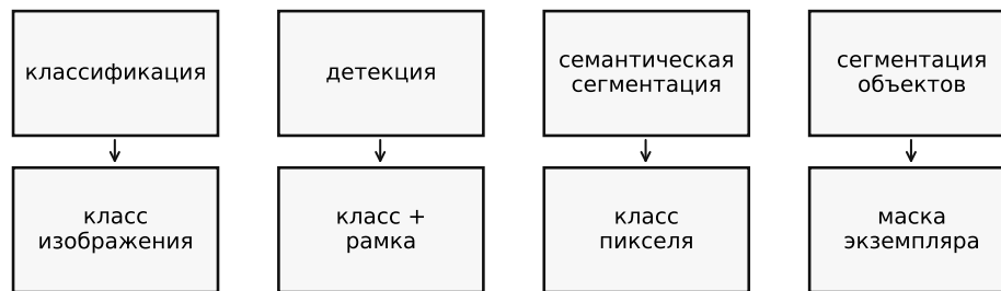
Рис. 12.4. Разные задачи компьютерного зрения используют одну сверточную основу, но разные выходные головы.
